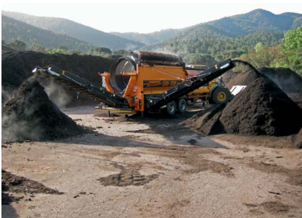
Le criblage permet d'obtenir le produit fini
