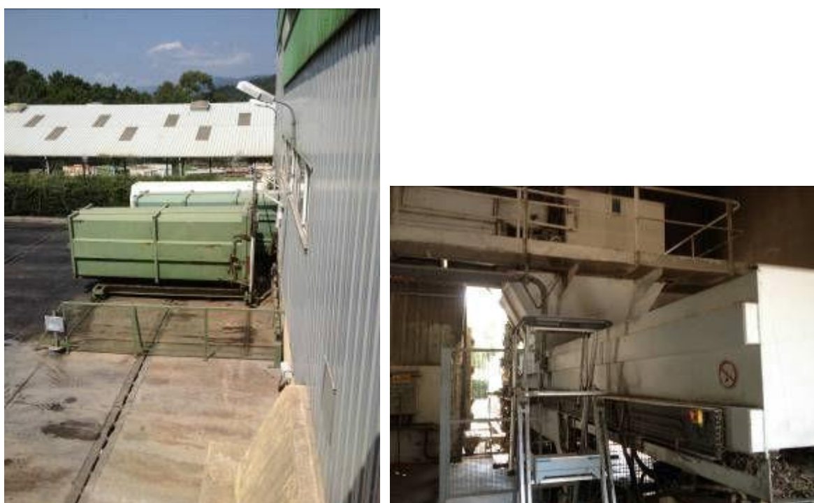
Le compacteur pour les OMR (photo de droite) et les caissons alimentés par ce dernier (photo de gauche)
