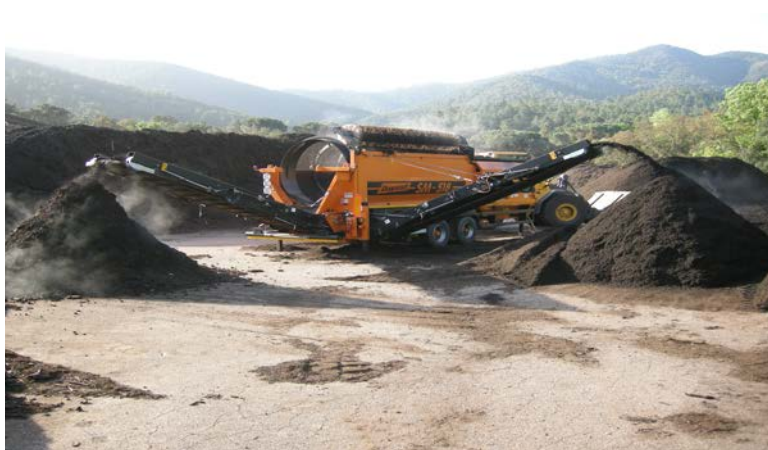
Le criblage permet d'obtenir le tas de compost
