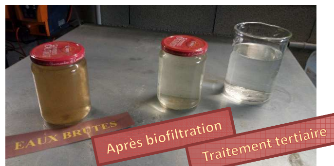
Comparaison process de traitement
