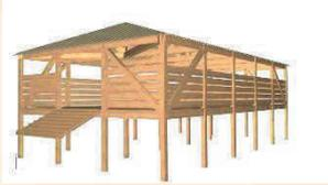
Le concept d'un équipement pastoral de type bergerie en bois sur pilotis, permettant de mettre en sécurité un troupeau d'ovin d'environ 400 têtes et son éleveur le temps de la submersion des terres (12 à 36 h), est proposé au cœur du champ d'expansion des crues de la Giscle dans une zone d'aléa faible à modéré (peu de vitesses).
